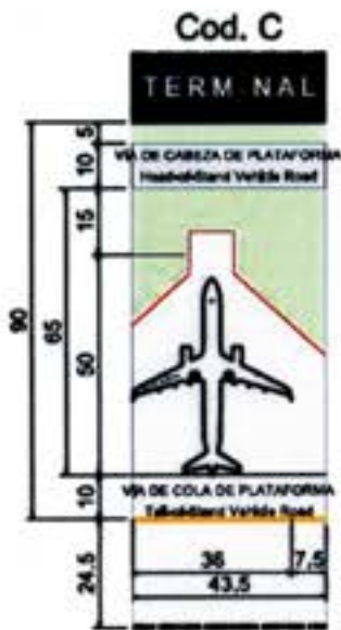
Figura 6-19: Profundidad de posiciones para aeronaves – Código C
